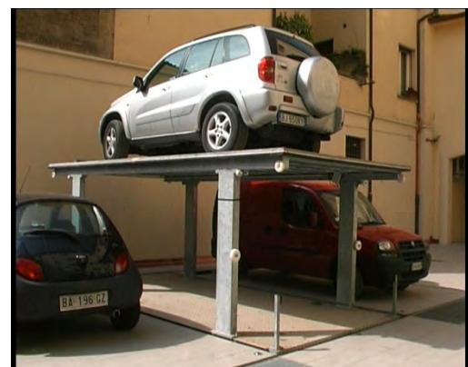
**SISTEMA DI PARCHEGGIO A PANTOGRAFO**
